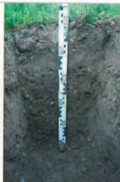
Abbildung 8 Kleinprofil 11/20, ziemlich flachgründige Auffüllung
