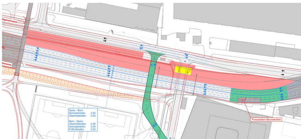
Abbildung 88: 2. Hauptetappe Absenkung N06, Bauphase 4
