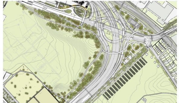
Abbildung 55: Variante Mauern unten, Böschungen 2:3 oben
