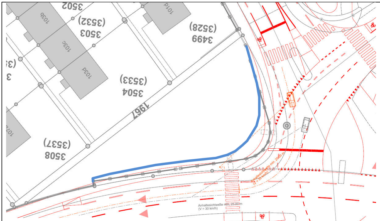
Abbildung 6: Lärmschutzwand Schermenweg / Bolligenstrasse; neue, leicht versetzte Lage zur Einhaltung der Sichtweiten für die Verkehrssicherheit blau markiert (Quelle Planauszug: B+S AG)
